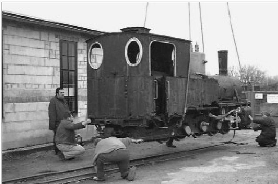
Im September 2004 erfolgte bei der MALOWA die Zerlegung. Führerhaus einschl. Kohle- und Wasserkästen sowie Kessel und Fahrwerkrahmen sind nun für eine Begutachtung frei zugänglich. Bei unserem Besuch im Oktober galt unser besonderes Interesse den ausgebauten Luttermöller-Antrieben. Im nächsten Schritt wird der Fahrwerkrahmen gesandstrahlt und der innere Wasserkasten begutachtet. Darauf aufbauend können wir entsprechend unseren finanziellen Mitteln den nächsten Restaurierungsschritt beauftragen.
