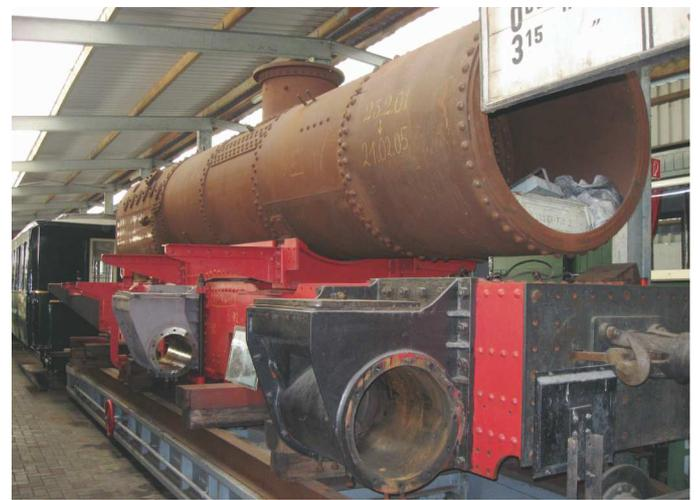
An Malletlok 7 wurden die ausgebohrten und grundierten Hochdruckzylinder montiert. Bruchhausen-Vilsen, 3.10.2015, Foto: Dennis Mellerowitz
