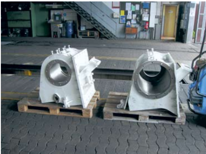
Abgeschliffene und ausgebohrte Hoch- und Niederdruckzylinder von Mallet 7 s , Foto: Dennis Mellerowitz
