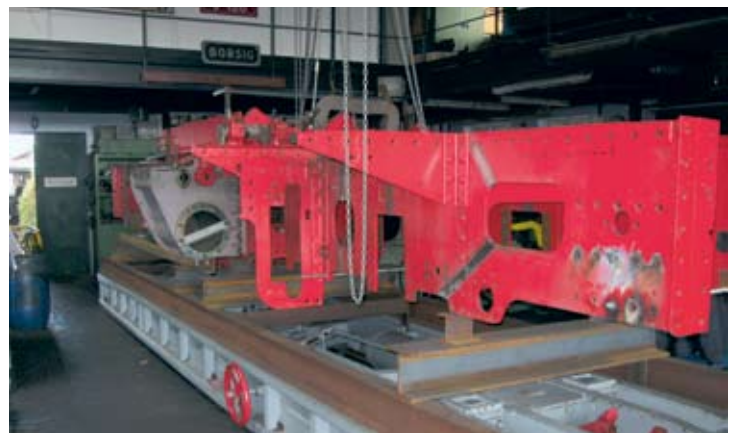
Die Schweißstellen am Rahmen von Malletlok 7 s sind plangeschliffen. Bruchhausen-Vilsen, 18. September 2016, Foto: Dennis Mellerowitz
