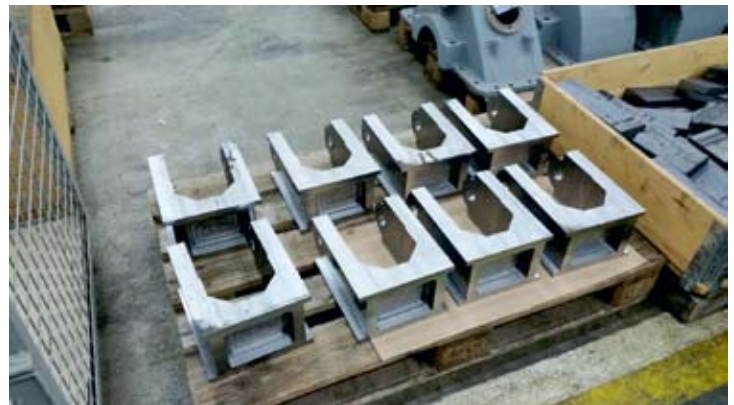
Nachgefertigte Achslagerkästenrohlinge für die Lok 7 s . 13. Oktober 2016, Foto: Ralf Hormann
