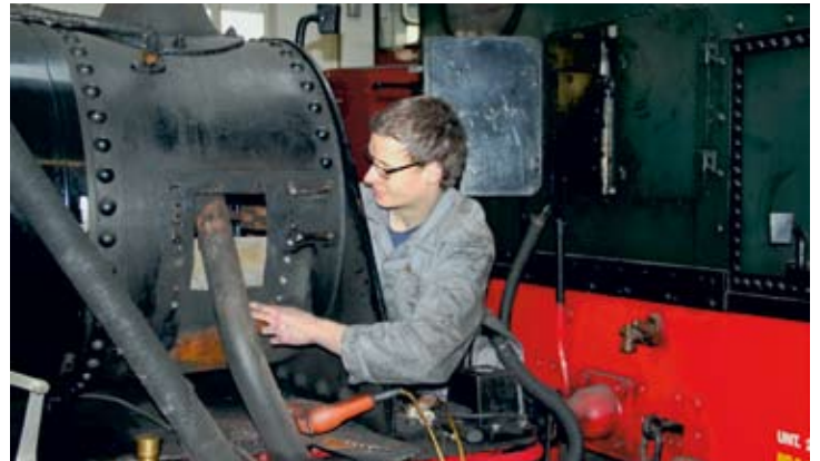
Viel Anpassungsarbeit erforderte die Fertigung der Dichtungsbleche für die Abdampfrohre der FRANZBURG. Maximilian Hensel nahm die Herausforderung gerne an. 18. Februar 2018
