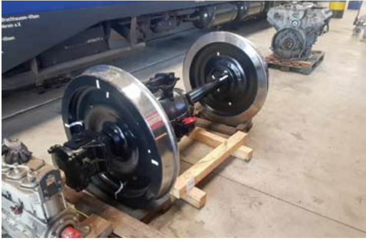
Frisch aus einer Fachwerkstatt eingetroffen ist die reparierte Antriebsachse des Triebwagens T 1 und wartet nun auf den Wiedereinbau. Hoya, 12. Mai 2020, Foto: Daniel Bergmann
