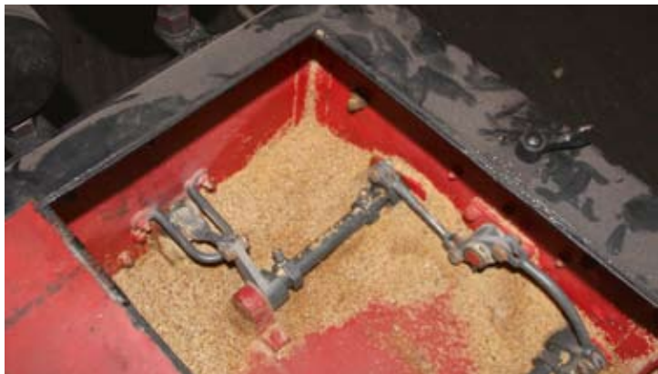
Ein Blick ins Innere des demontierten Sandbehälters der PLETTENBERG: Die Mechanik bleibt sonst verborgen. 15. Februar 2020, Foto: RM
