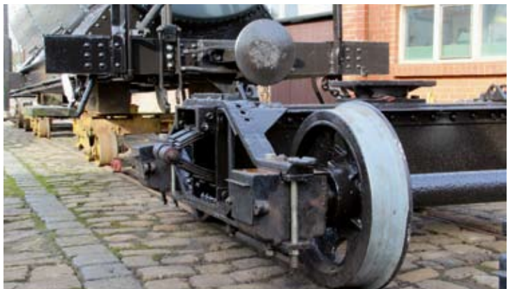
Beim Frühjahrsmeeting wurden die Drehgestelle von Kesselwagen 152 wieder zusammengebaut. Fotos: 15. (oben) bzw. 21. Februar 2020, Fotos: Uwe Franz bzw. RM
