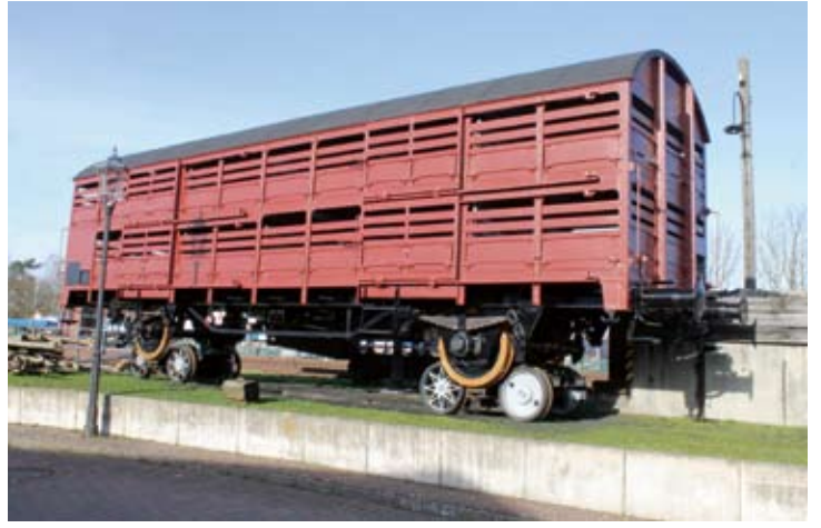
Bis auf die Beschriftung fertiggestellt ist der Viehverschlagnwagen Gw 8. Man beachte die neuen Radsätze mit dicken Radreifen! Bruchhausen-Vilsen, 15. Februar 2020. Foto: Slg. Uwe Franz
