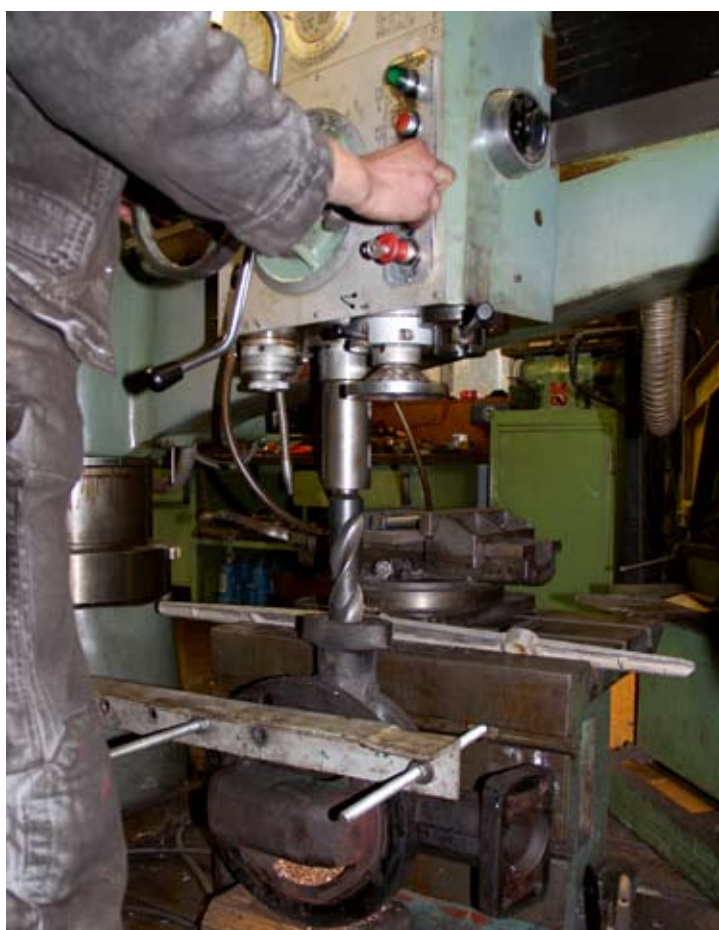
Das Lager der Reglerstange der PLETTENBERG musste ausgebohrt werden. Max Hensel hatte es hierzu an der Bohrmaschine sorgsam eingespannt. 21. Februar 2020, Foto: RM
