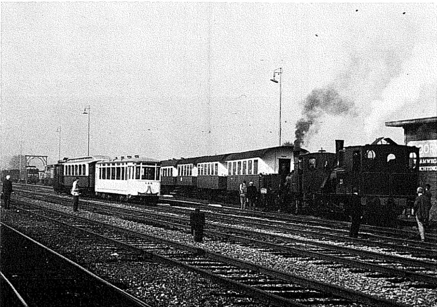
Doppeltraktion von Lok 30 und 18 in Medemblik. Aufgrund der verschiedenen Zug- und Stoßvorrichtungen müssen beide Loks mit dem Zwischenwagen gekuppelt werden.
