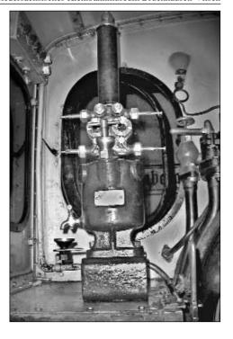
Oberhalb: Der aufgearbeitete De-Limon-Dampfsichtöler vormontiert auf Lok Spreewald. Die Anschlüsse fehlen noch, 8. 11. 2002, Foto: Wolfram Bäumer
