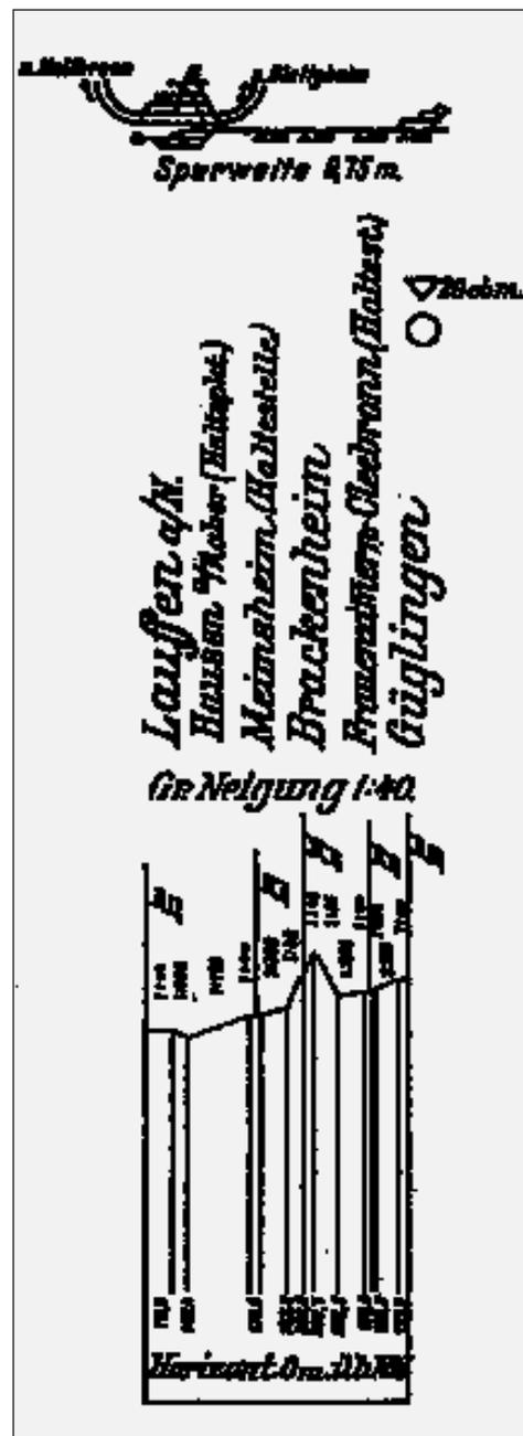
Oben: Höhenriß der Zabergäubahn im erst eröffneten Abschnitt. Die Höhenlage der Station Brackenheim über dem Zabertal mit den beidseitigen Steilabschnitten, welche die Bewährungsprobe für den DWss1 darstellten, erkennt man gut. Vorlage: Slg Peter Zeller
