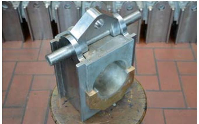
Bis auf den Achslager-Unterkasten vollständig neu gefertigtes Achssatzlager (auf dem Kopf stehend). Auch die anderen sieben Lager im Hintergrund mussten entsprechend bearbeitet werden. Vor dem Einbau müssen u. a. die Lagerausgüsse noch an die Achswellen angepasst werden.
