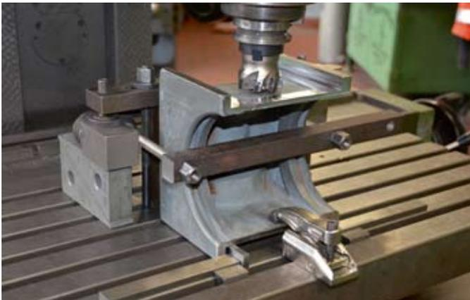
Nachbearbeitung durch Fräsen der aufgeschweißten Achslagerunterkästen in der Werkstatt in Bruchhausen-Vilsen. Diese Bauteile sind die einzigen der vielen Bauteile eines Radsatzlagers, die nicht vollständig erneuert werden mussten.
