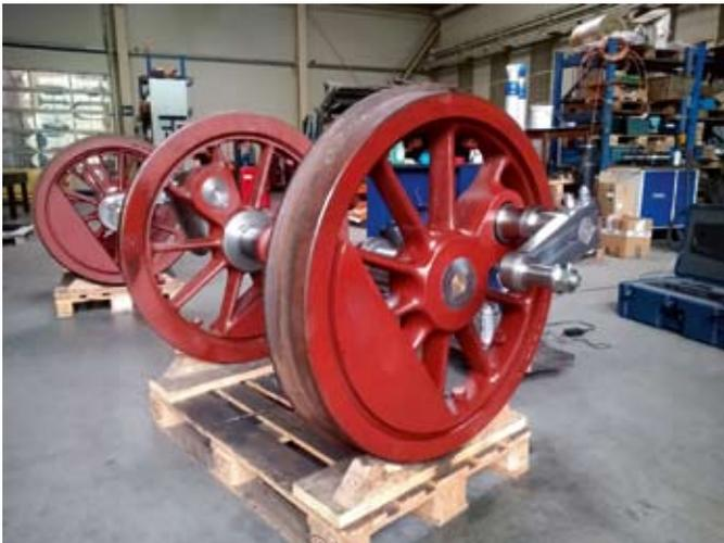
Die vier Treib- und Kuppelradsätze sind in einem Fachbetrieb in Olbernhau in Sachsen fertig aufgearbeitet worden: Hier die Treibradsätze nach Korrektur der erneuerten Treibzapfen mit aufgesetzter Gegenkurbel.
