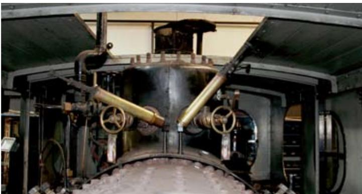
Das Innere der Dampflok PLETTENBERG, die gerade eine HU erhält: Teile der Kesselverkleidung, der Armaturen und des Dachs sind demontiert. Bruchhausen-Vilsen, 21. Juni 2021. Foto: RM
