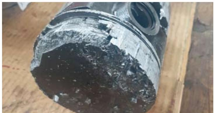
Am Inselbahnwochenende fiel der Triebwagen T 41 wegen eines Motorschadens aus: So sieht ein Kolbenfresser aus. Die Reparatur wird aufwändig und teuer... 22. Juli 2021. Foto: Lars Böcker
