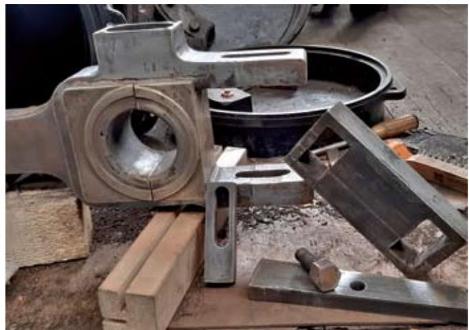
Das zerlegte Kuppelstangenlager „links hinten“ (Hochdrucktriebwerk) nach Reinigung zur Festlegung der notwendigen Instandsetzungsarbeiten. Kolben, Kreuzkopf und Steuerbock sind momentan noch bei einer Fachfirma in Arbeit, dann zeichnet sich auch beim Triebwerk „Licht am Ende des Tunnels“ ab. 22. Juni 2021. Vier Fotos: Thomas Meyer
