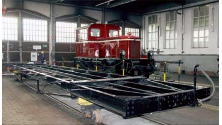
Der Rahmen von Wagen 7 ist bis auf die Drehgestelle fertig restauriert und bereit für die Aufnahme des Wagenkastens. Bruchhausen-Vilsen, 21. Juni 2021. Foto: RM
