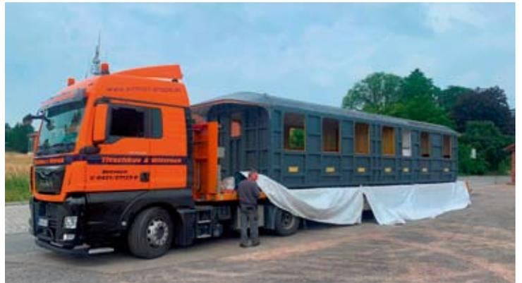
Am selben Tag trifft der für den Transport wetterfest eingepackte Wagenkasten per Lkw in Bruchhausen-Vilsen ein und kann per Auto-kran auf den Rahmen gesetzt werden. Foto: Nils Böcker
