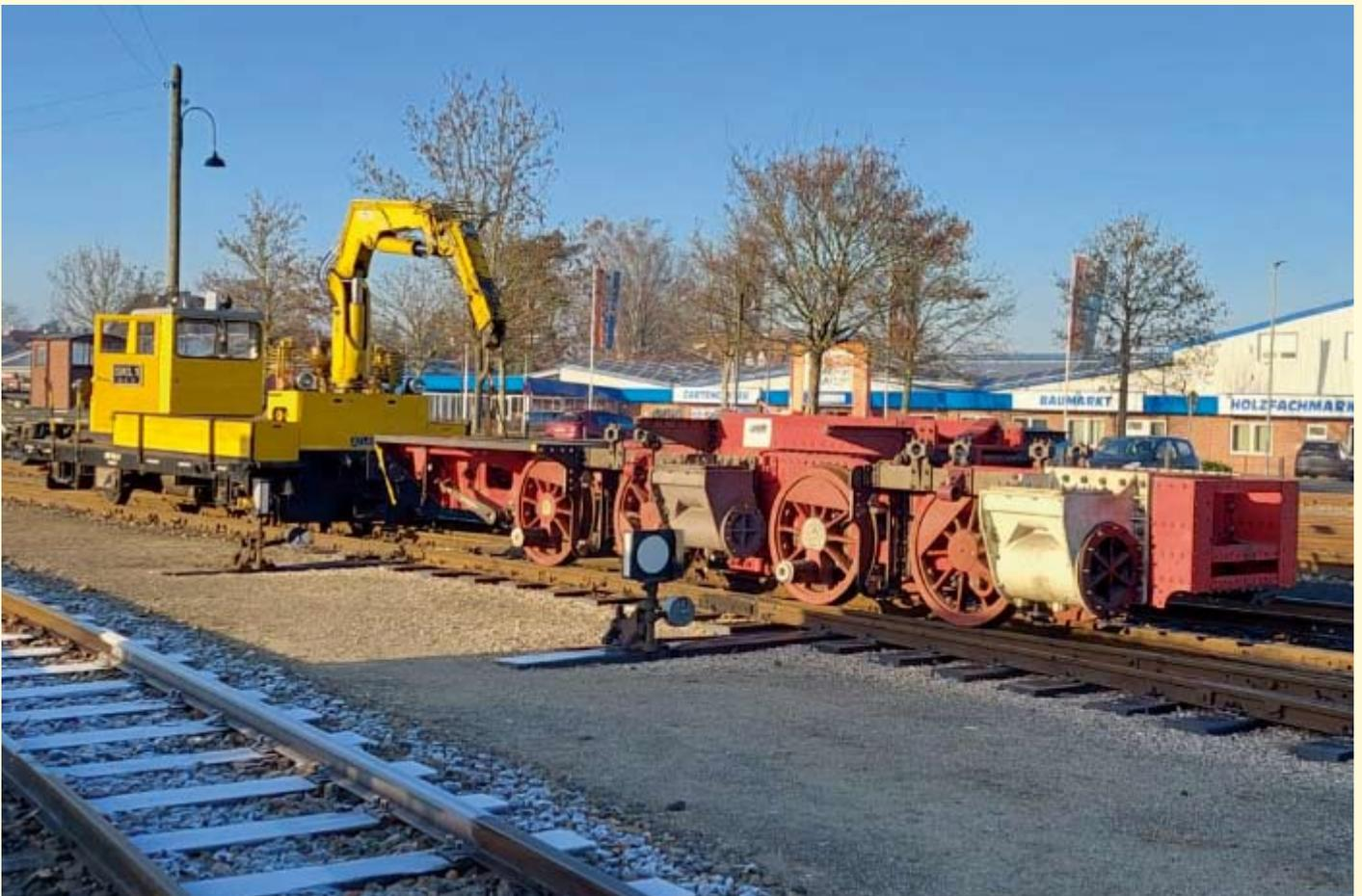
Am 21. Dezember 2021 unternahm das frisch eingeachste Mallet-Fahrwerk der Lok 7<sup>s</sup> seine ersten Rollversuche im winterlichen Sonnenschein und bei klirrender Kälte vor der Werkstatt in Bruchhausen-Vilsen. Foto: Ralf Hormann
