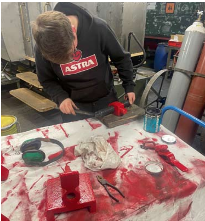
Auch am Rollwagen Nr. 178 wird gearbeitet. In der Fahrzeughalle widmete sich Jonas Kindermann der Entrostung und Neulackierung der Ausrüstungsteile. Bruchhausen-Vilsen, 19. November 2022. Foto: Lars Böcker
