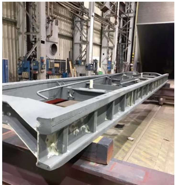
Der Rollwagenrahmen selbst ist in einer Lackiererei bearbeitet worden und hat schon einen Anstrich bekommen, 1. Februar 2023. Foto: Stefan Trachsel
