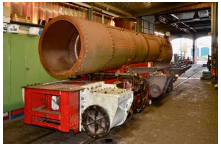
Der für Anpassungsarbeiten provisorisch auf das Fahrwerk der Lok aufgesetzte Kessel.
