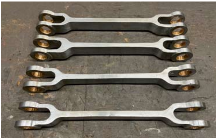
Die vier fertig aufgearbeiteten Hängeeisen der Heusinger-Steuerung mit Bronze-Gleitlagerbuchsen.
