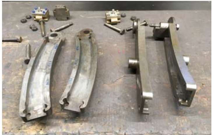
Die alten Taschenschwinge mit ihrer komplexen Geometrie müssen durch Neuteile ersetzt werden.
