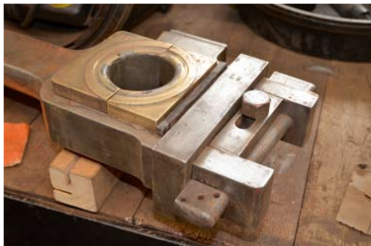
Eine der noch unbearbeiteten Treibstangen mit hinterem Gleitlager und offenem Stangenfenster samt Flachstellkeil.
