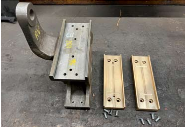
Der Kreuzkopf für das rechte Niederdrucktriebwerk samt zugehöriger Rotguss-Gleitplatten.
