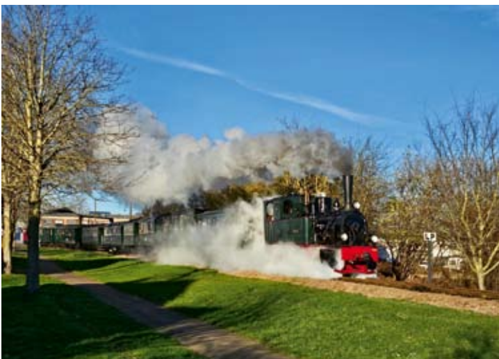
Nach dem Mittag machte sich die HOYA wieder auf zur Fahrt mit einem Nikolauszug Richtung Heiligenberg und Asendorf. Durch die geöffneten Zylinderhähne nach Abfahrt von Bruchhausen-Vilsen wurden die ersten Wagen von der Dampfwolke verhüllt. 01.12.2024, Foto: RM
