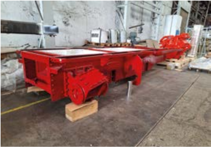
Der FRANZBURG-Rahmen konnte nach dem Sandstrahlen und erstem Lack in rot beim Beschichtungsbetrieb in Bremen aufgenommen werden. 14.10.2025, Foto: Uwe Franz
