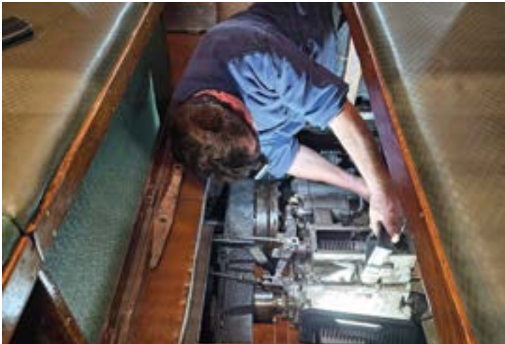
Beim Mylius-Getriebe des T42 „hakelte“ zum Ende der Saison mal wieder. Sascha Traulle und Holger Hohenkamp (unter dem Fahrzeug) reparierten den Triebwagen für die kommenden Einsätze. 04.10.2025, Foto: RM
