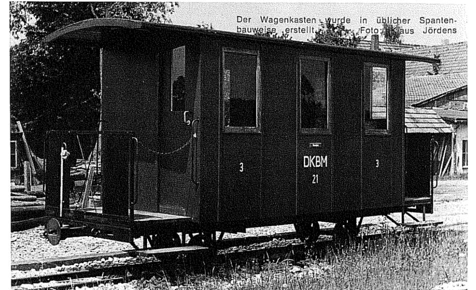
Der Wagenkasten wurde in üblicher Spantenbauweise erstellt. Foto: Klaus Jördens
