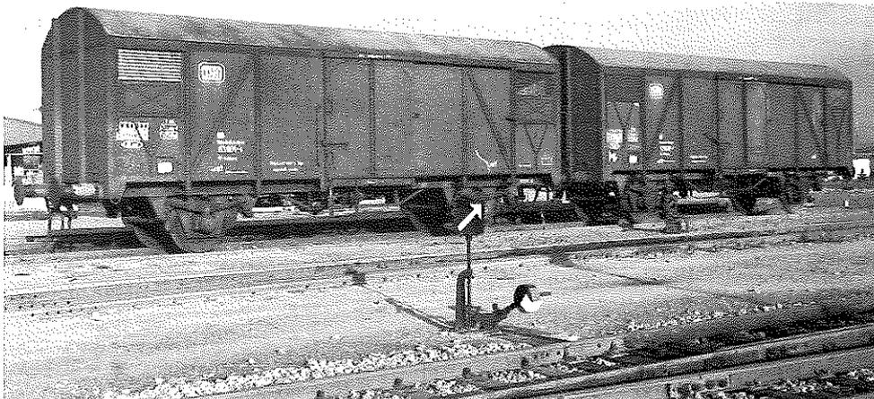
Kleinbahn-typischer Weichenhebel mit Signalscheibe im Bahnhof Bruchhausen-Vilsen. Die roten Ecken am Stellgewicht weisen auf eine Weiche ohne Verschluß hin.
