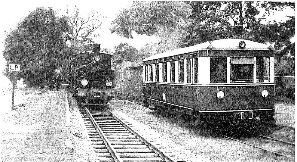
Zugkreuzung am 1. September 1984 in Heiligenberg. Der T 42 unterwegs in Richtung Bruchhausen-Vilsen trägt die Zugschlußscheiben in den oberen Scheibenhaltern, genau wie es auch auf den FKB praktiziert wurde. Den Gegenzug nach Asendorf zieht die Lokomotive SPREEWALD.
