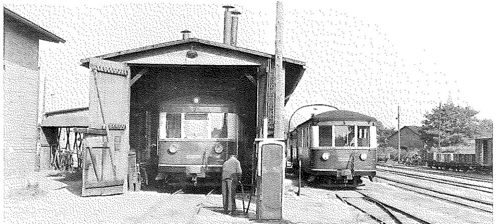
Triebwagen-Kleinbahn-Romantik im August 1966 gelungen im Bahnhof Barth eingefangen. Während der VT 137 532 noch im Triebwagenschuppen Luft pumpt, um ausrücken zu können, macht der Fahrer schon mal den Schlauch klar, damit er den Triebwagen anschließend auftanken kann. Auf dem vordersten Ende des Güterschuppengleises steht der zum Beiwagen degradierte ehemalige T 1 der FKB.
