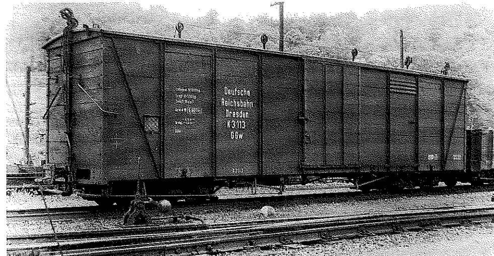
Güterwagen am 29. 5. 1946 im Bahnhof Frettal-Potschappel. An der Stirnseite befindet sich die Ausklinkvorrichtung. Die Bremse ist gerade ausgeschaltet. Bei dieser Konstruktion hängt das Gewicht am Drehgestell. Daher wird von der Stirnseite zur Wagenmitte die Seil-„Information“ mittels einer am Drehgestell vorbeiführenden Stange zur Wagenmitte weitergeleitet, wo sie über Hebel und weitere Stangen zu den Drehgestellen gelangt. Foto: RBD Dresden
