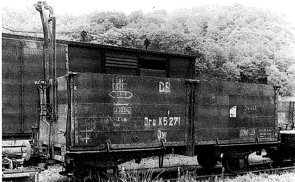
Güterwagen am 30. 5. 1946 im Bf. Freital-Potschappel mit Heberleinbremse. Die niedrigen offenen Güterwagen besaßen an einer Stirnseite eine Stütze für die Führungsrolle, damit das Seil über hohe Ladungen geführt werden kann. Bei dieser einfachen Konstruktion ist die Hubrolle direkt an der Stange gelagert. Die Bremse ist ausgeschaltet. Die Bremskraft entsteht am linken Radsatz und wird mittels einer Zugstange zum rechten Radsatz geleitet. Foto: RBD Dresden
