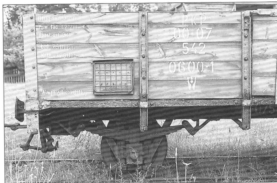
*Oben: Im Dienstgüterverkehr für die Dampfloksonderfahrten werden die kleinen Lenz-Wagen immer noch eingesetzt. Mit dem Ladegewicht der Kohlen hat man es nicht so genau genommen. Der Wagen hat noch die ursprünglichen T-Profile an den Seitenwänden, 21. 7. 1993*
